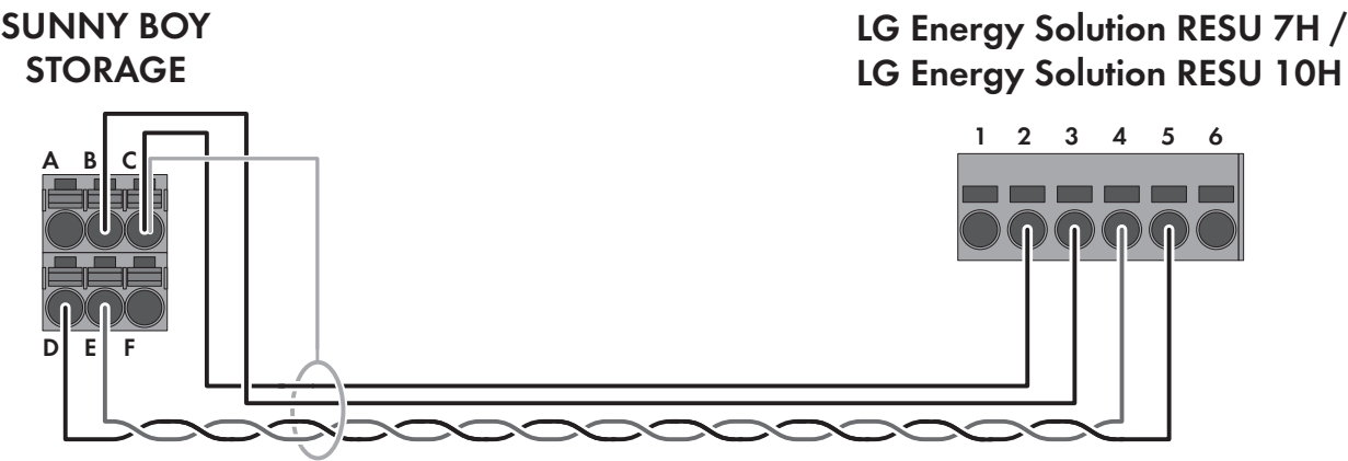
Abbildung 1: Verkabelungsprinzip SBS2.5-1VL-10 mit RESU 7H / RESU 10H
